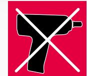
Ne pas utiliser d'outil électrique ou pneumatique pour actionner l'extracteur.
