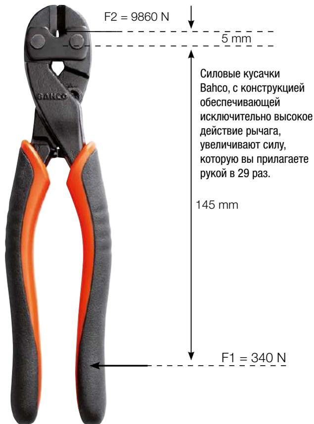
Силовые кусачки Вагсо, с конструкцией обеспечивающей исключительно высокое действие рычага, увеличивают силу, которую вы прилагаете рукой в 29 раз.
