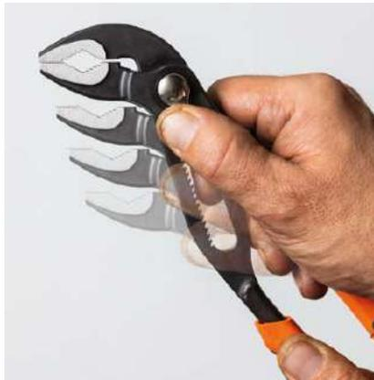
Еще один запатентованный механизм быстрой регулировки Quick-Adjust в серии 722X, который обеспечивает очень интуитивное управление. Просто поверните кнопку, чтобы открыть губки. Для закрытия губок вы можете просто закрыть рукоятки, не используя кнопку.
