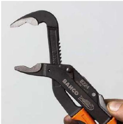
Запатентованный механизм быстрой регулировки ERGO™ Quick-Adjust позволяет регулировать открытие губок одной рукой. Эта уникальная функция дает вам больше возможностей для работы с клещами в любой ситуации и снижает риск мышечной усталости и травм.
